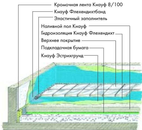
Наливные монолитные полы Кнауф могут покрываться всеми обычными напольными покрытиями: ковровые напольные покрытия, ПВХ, линолеум, плитка, паркет, ламинат, прочие покрытия. Швы в монолитных полах всегда должны переноситься и на верхнее покрытие.
