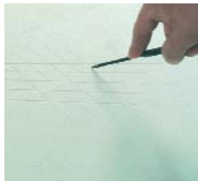
Проба на твердость методом царапин
